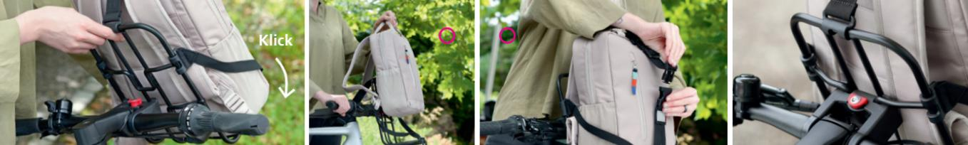
Der universelle, abnehmbare Gepäckträger kann in zwei Höhen am Lenker Adapter angeklickt werden. Die Kupplung von oben auf den Adapter setzen und zum Verriegeln nach unten schwenken. Mit dem großen, zentralen Steckverschluss ist das Gepäck auf der breiten Auflagefläche ruckzuck verspannt. Das verstellbare Gurtband mit Reflektor lässt sich einfach auf der leichten Aluminiumstruktur anklipsen. Durch Drücken der roten Taste wird das Rack gelöst.
